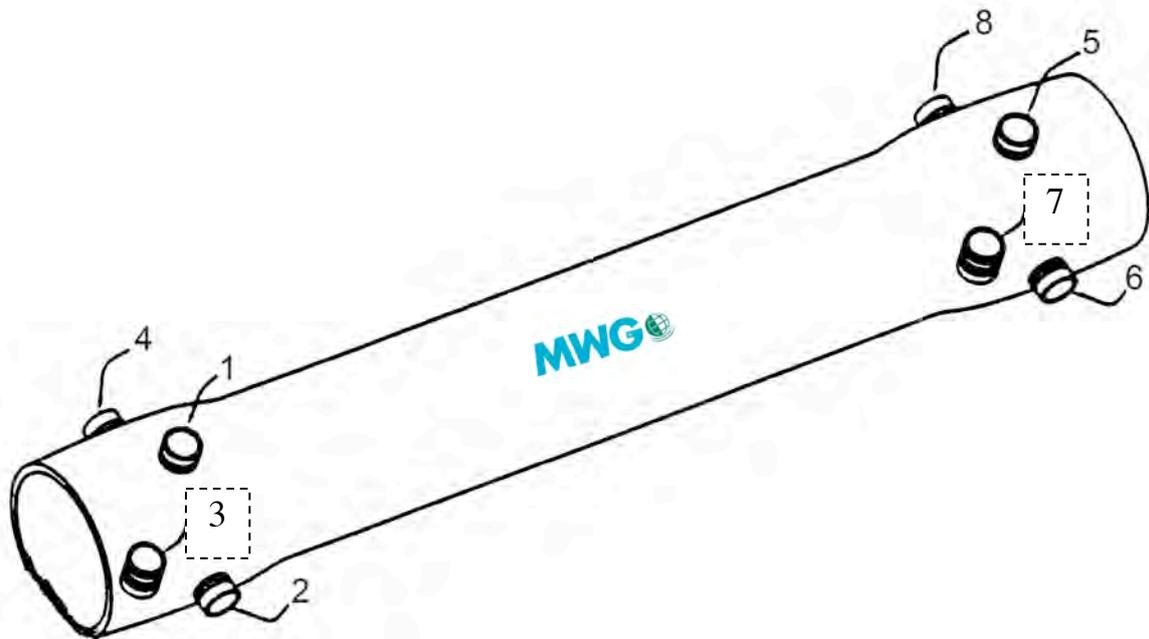
Per determinare la configurazione richiesta dal vessel, identificare le porte partendo dalla numero 1 con relativo attacco, completare da un lato e identificare il lato opposto. Il disegno indica i numeri delle diverse posizioni.
