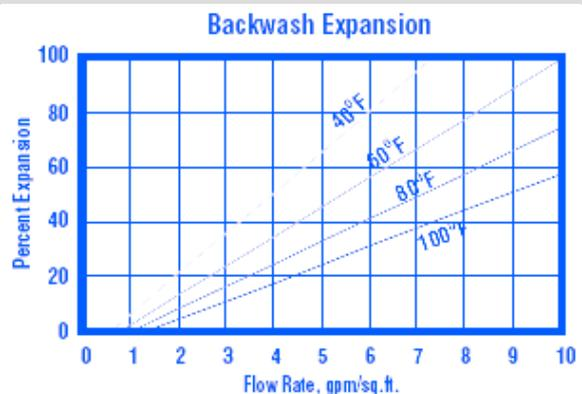
**Controlavaggio:** dopo ogni ciclo il letto di resina dovrebbe essere controlavato in modo tale da espandere il letto dal 25 al 50 %. Ciò rimuoverà ogni corpo estraneo e ricomporrà il letto. Il grafico sopra mostra le caratteristiche di espansione della resina Pure PC002 in forma sodica.
