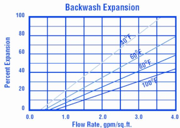
**Controlavaggio:** dopo ogni ciclo il letto di resina dovrebbe essere controlavato in modo tale da espandere il letto dal 50 al 75%. Ciò rimuoverà ogni corpo estraneo e ricomporrà il letto. Il grafico sopra mostra le caratteristiche di espansione della resina Pure PA103.
