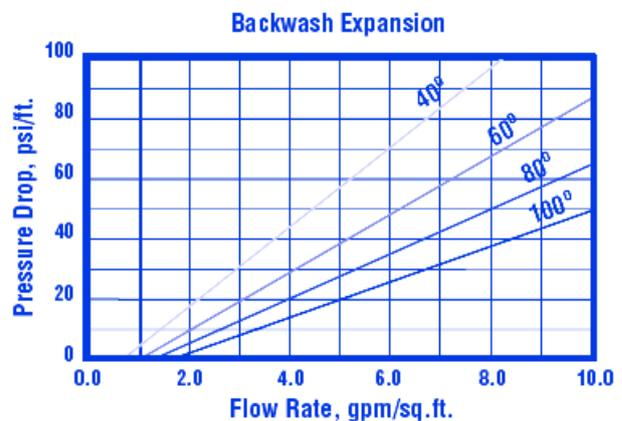
**Controlavaggio:** dopo ogni ciclo il letto di resina dovrebbe essere controlavato in modo tale da espandere il letto dal 25 al 50%. Ciò rimuoverà ogni corpo estraneo e ricomporrà il letto. Il grafico sopra mostra le caratteristiche di espansione della resina Pure PC100.
