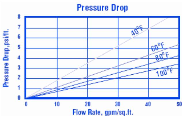
**Perdita di carico:** il grafico sopra mostra il  $\Delta p$  previsto per altezza di letto pari a un piede in funzione della portata a varie temperature.
