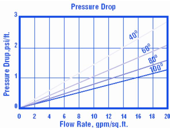
**Perdita di carico:** il grafico sopra mostra il  $\Delta p$  previsto per altezza di letto pari a un piede in funzione della portata a varie temperature.
