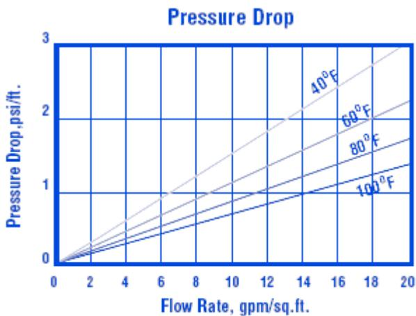
**Perdita di carico:** il grafico sopra mostra il  $\Delta p$  previsto per altezza di letto pari a un piede in funzione della portata a varie temperature.
