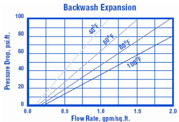
**Controlavaggio:** dopo ogni ciclo il letto di resina dovrebbe essere controlavato in modo tale da espandere il letto dal 50 al 75%. Ciò rimuoverà ogni corpo estraneo e ricomporrà il letto. Il grafico sopra mostra le caratteristiche di espansione della resina Pure PA300.
