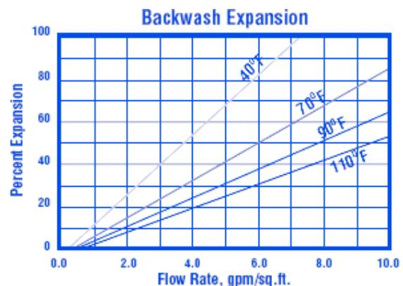
**Controlavaggio:** dopo ogni ciclo il letto di resina dovrebbe essere controlavato in modo tale da espandere il letto dal 25 al 50%. Ciò rimuoverà ogni corpo estraneo e ricomporrà il letto. Il grafico sopra mostra le caratteristiche di espansione della resina Pure PC003 in forma sodica.
