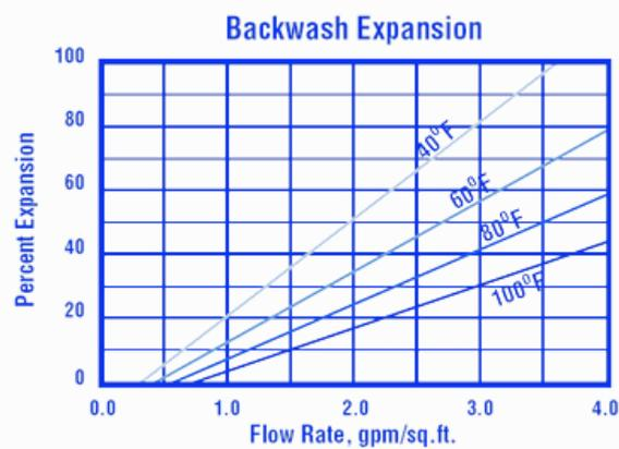
**Controlavaggio:** dopo ogni ciclo il letto di resina dovrebbe essere controlavato in modo tale da espandere il letto dal 50 al 75%. Ciò rimuoverà ogni corpo estraneo e ricomporrà il letto. Il grafico sopra mostra le caratteristiche di espansione della resina Pure PA101 IND-1.
